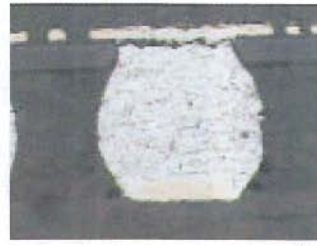
Bild 12: Typischer Querschnitt einer fehlerhaften SnAgCu-Lötverbindung
