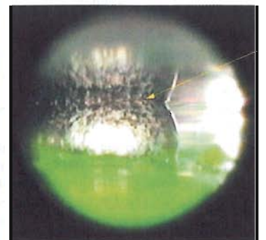
Bild 17: Delaminierte Eckkugel des BGAs
