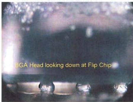
Bild 13: Standard BGA-Optiksysteme können nur die unterseitigen Lötverbindungen darstellen
