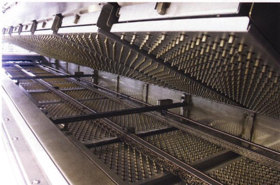
Geöffnete Hotflow mit Heizkassetten
