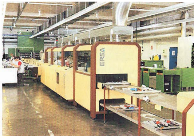
Bild 2: Klassische Fertigungslinie mit Wellenlötanlage und Handarbeitsplätzen
