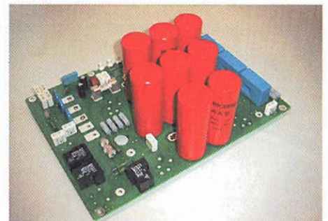
Bild 3: Bleifrei selektiv gelötete Baugruppe, die zuvor beim Handlöten und maschinellen Wellenlöten immer wieder Probleme durch „Lot-Durchsteiger“ verursachte
