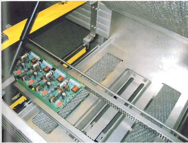
Bild 4: Für höchste Anforderungen bleifreier Lötprozesse ausgelegte Sprühfluxereinheit
