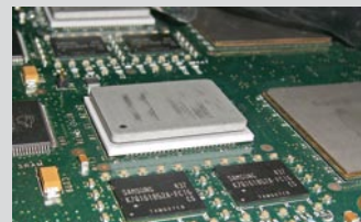
Rework von massereichen Bauteilen auf dicken, großformatigen Leiterplatten
