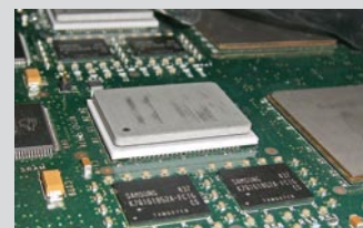
Rework von massereichen Bauteilen auf dicken, großformatigen Leiterplatten
