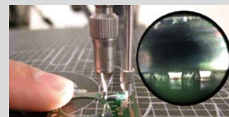
Abstand zw. Flip-Chip-Optik und Bauteil: ca. 30 µm
